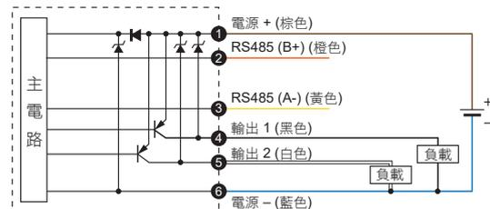
※ 通訊產品 (RS485) 之接線，須先接通訊線，再接電源線，避免短路情況發生，導致產品損壞。
